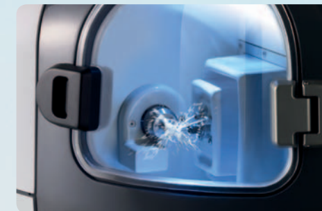
Intelligentes, 4-achsiges Schleifen einer Krone.
